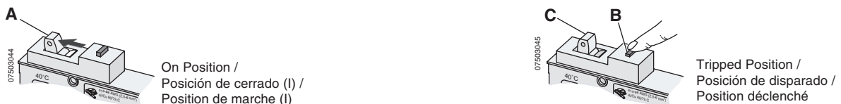
Figure / Figura / Figure 2 : Circuit Breaker Testing / Prueba del interruptor automático / Essais du disjoncteur
